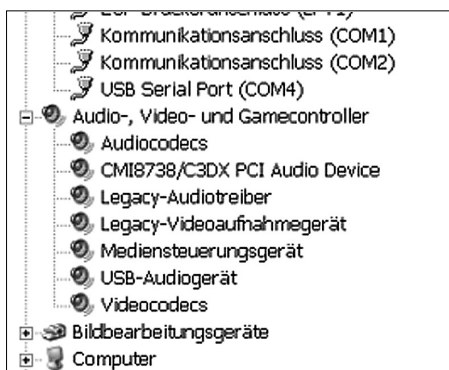
Bild 18: Hat alles geklappt, erscheinen die Geräte USB Serial Port und USB Audiogerät unter Windows im Geräte-Manager.
