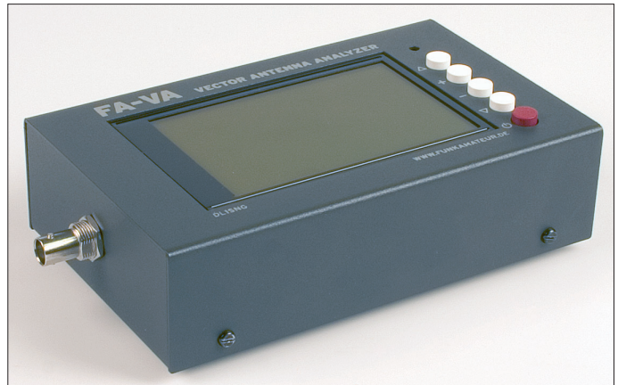
Bild 1: FA- Antennenanalysator in dem zum Bausatz gehörenden Stahlblechgehäuse
